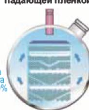
Технология со сплошной падающей пленкой позволяет на 40% сократить объем заправки хладагента по сравнению с испарителем затопленного типа
